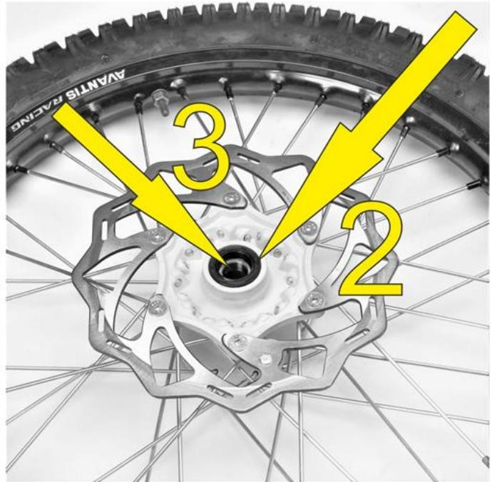
Установите переднее колесо в вилку и просуньте ось колеса [4] через зажимы и ступицу колеса.
