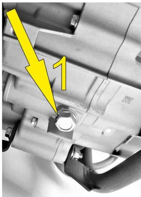
Установите сливной болт [1] в корпус двигателя и затяните с моментом (15 Нм).
